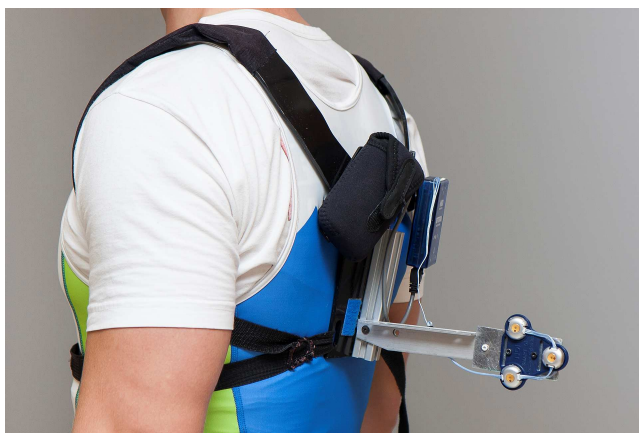
Slika 6.3: Brezžični merilni markerji nameščeni na oprtnik za merjenje naklona trupa.
