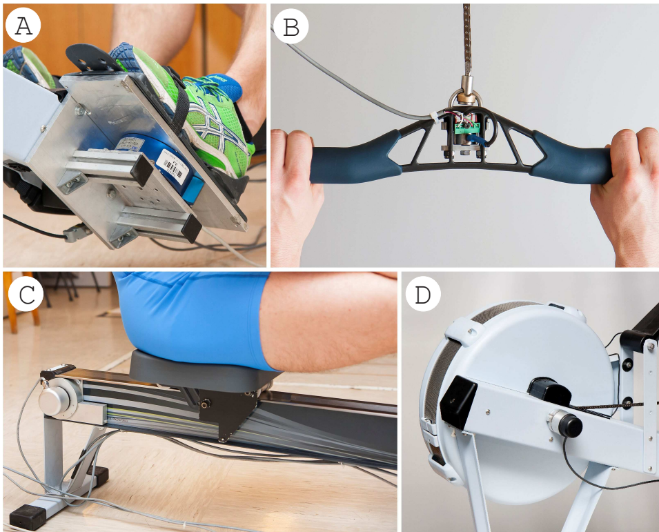
Slika 6.2: Senzorji pritrjeni na simulator veslanja.
