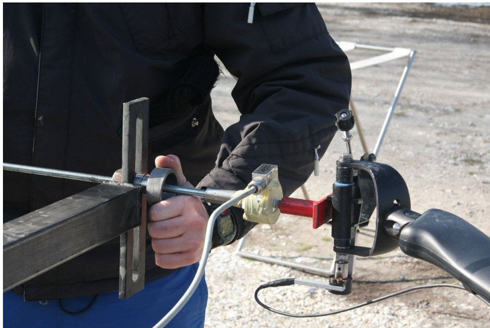
Slika 5.5: Umerjanje senzorjev sile pred meritvijo sil na vodi.
