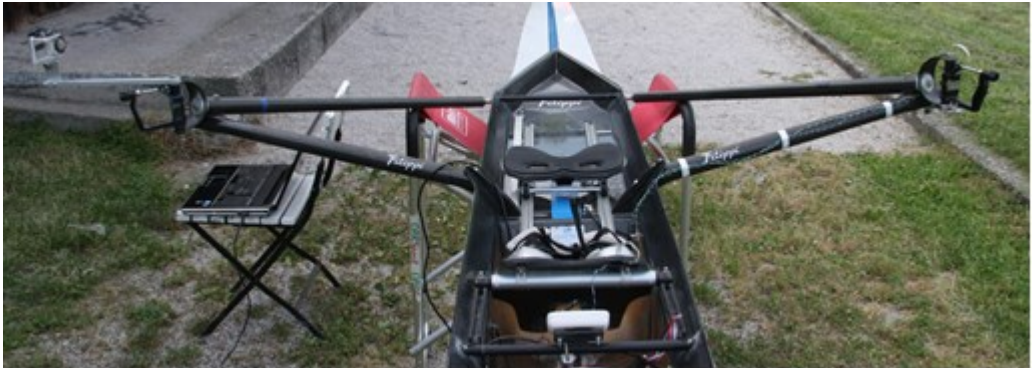
Slika 4.2: Enojec z nameščenimi senzorji za silo na objemkah vesel, silo nog pod čevljem, senzorjem za vodoravni kot vesla in senzorjem premika sedeža [38].
