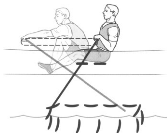
Slika 4.3: Gibanje vesla med zavesljajem.
