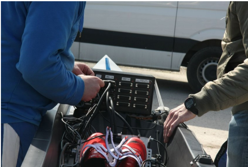
Slika 4.9: Primer centralne enote multiparametričnega sistema za zajemanje osnovnih veličin za štiri veslače v dvojnem četvercu [46].
