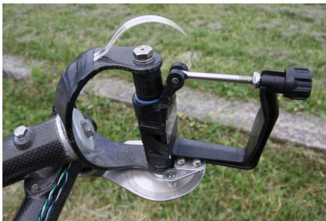
Slika 4.15: Merjenje sile na objemki vesla s pomočjo takoplastnih folijskih senzorjev [38].
