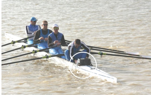
Slika 4.22: Instrumentalizirani dvojni četverec [46]. Obkrožena je centralna merilna enota. Na izbočnikih so vidni kabli posameznih senzorjev.
