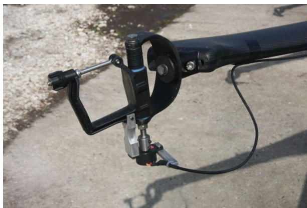
Slika 4.19: Sistem za merjenje vodoravnega kota objemke vesla [46].
